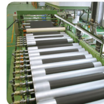
8 Cooling Unit 冷卻機
