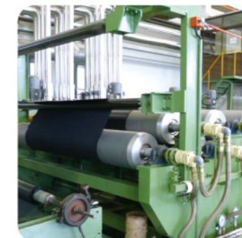
10 Cooling Unit 冷卻機
